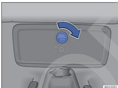
**Fig. 164** En el piso del asiento trasero: acceso a la caja de fijación de las herramientas de a bordo.
