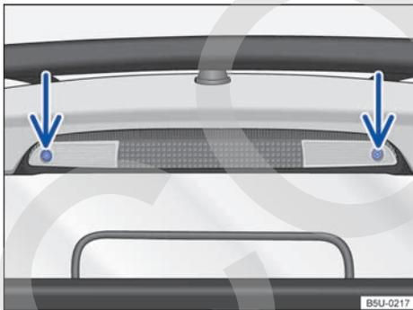
**Fig. 193** En el compartimento de carga: remover la linterna de freno elevada.
