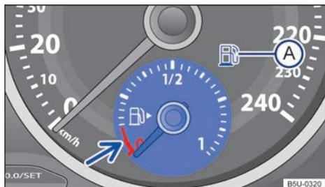
**Fig. 132** En el instrumento combinado: indicador del nivel de combustible (variante 2).
