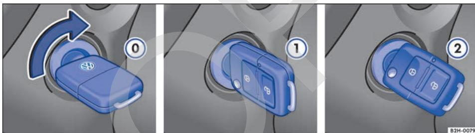
**Fig. 107** Al lado del volante, a la derecha: posiciones de la llave del vehículo en el cilindro del encendido.
