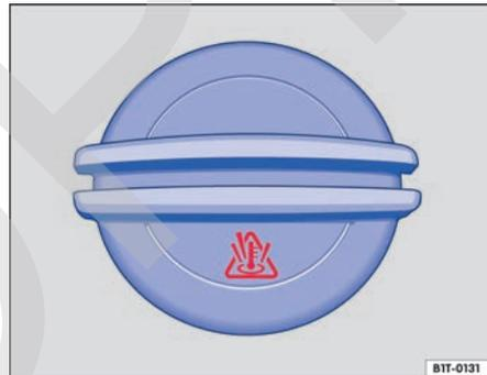
Fig. 141 En el compartimento del motor: tapón del depósito de expansión del líquido refrigerante de motor.
