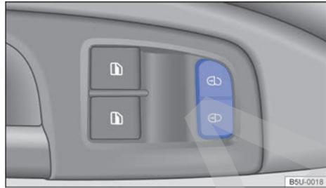
**Fig. 25** En la puerta del conductor: tecla del cierre centralizado.
