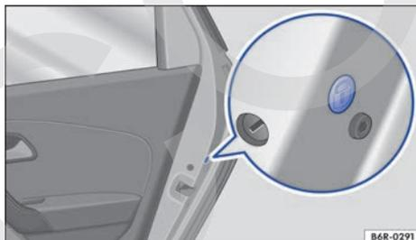
Fig. 160 En la parte delantera de la puerta derecha: bloqueo de emergencia, cubierto por una junta de goma.
