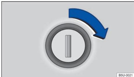
**Fig. 28** Bombín de cierre para bloquear y desbloquear la tapa del compartimento de carga.
