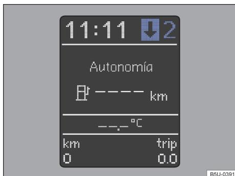
Fig. 112 En el panel de instrumentos : indicador de cambio de marcha (variante 2).
