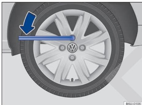
Fig. 172 Cambio de rueda: afloje los tornillos de la rueda.
