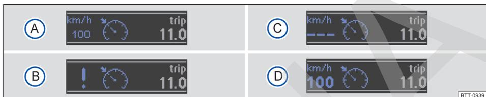
Fig. 125 En el display del panel de instrumentos: indicadores de estado del GRA.
