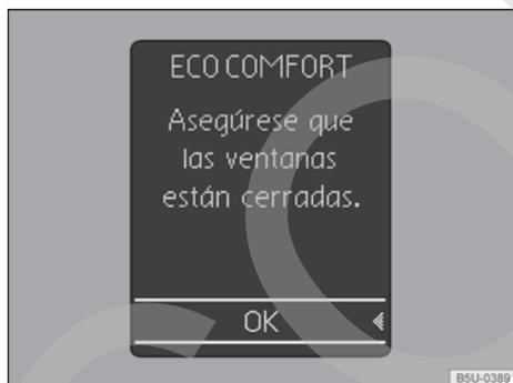
Fig. 14 En el panel de instrumentos: texto de advertencia del ECO Comfort.
