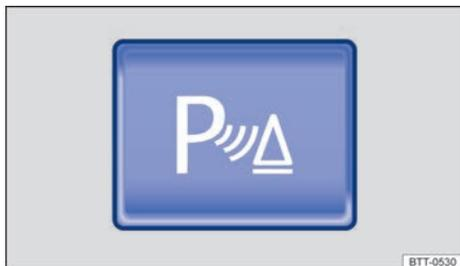
Fig. 120 En la parte superior de la consola central: pulsador para activar y desactivar el control de distancia de aparcamiento (Park Pilot).
