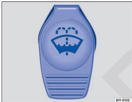
**Fig. 72** En el compartimento del motor: tapa del tanque de agua de los lavaparabrisas.
