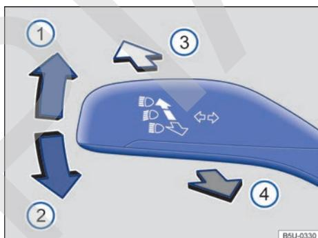
**Fig. 63** palanca de los indicadores de dirección y del farol alto / de largo alcance.
