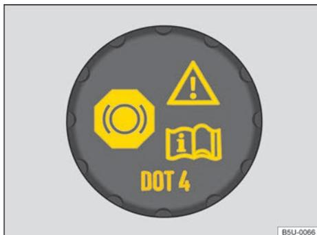
**Fig. 115** En el compartimento del motor: tapa del depósito de líquido del freno.
