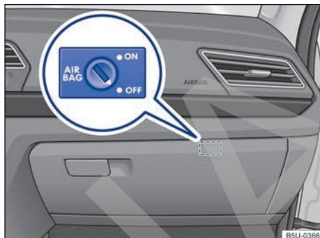
**Fig. 61** En la guantera: interruptor desaccionado por la llave para apagar y encender el airbag frontal del pasajero.
