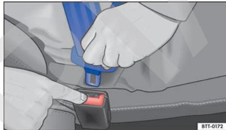
Fig. 53 Soltar la lengüeta del cinturón de seguridad del cierre del cinturón.
