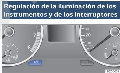
**Fig. 66** En el panel de instrumentos: tecla de regulación de la iluminación de los instrumentos y de los interruptores.
