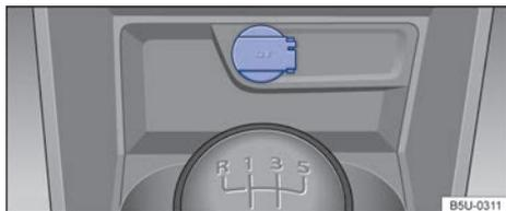
**Fig. 102** En la consola central delantera: toma de corriente de 12 V.
