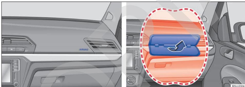
Fig. 60 Ubicación y radio de expansión del airbag frontal del acompañante.
