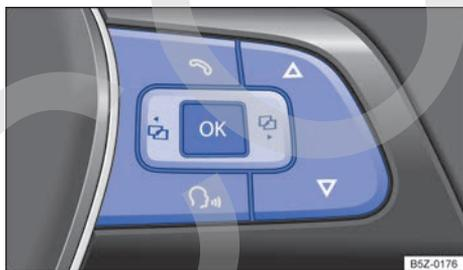
**Fig. 13** Lado derecho del volante multifunción: teclas de comando de los menús del panel de instrumentos.
