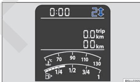
Fig. 111 En el panel de instrumentos : indicador de cambio de marcha (variante 1).
