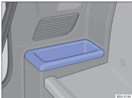
Fig. 94 En el lateral del compartimento interno de equipaje: portaobjetos.
